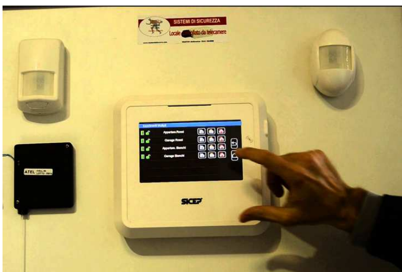
Figura 3 Esempio rappresentativo di una centrale di allarme
